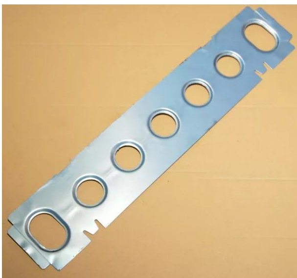
Деталь В - усилитель порога
