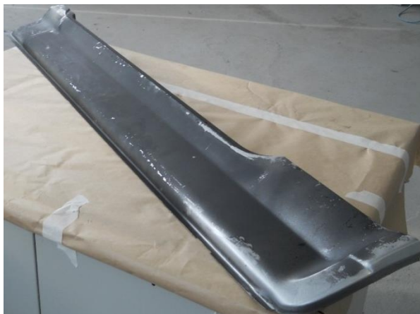
Деталь А - наружная панель порога
