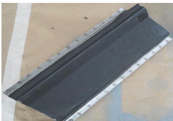
Коробчатая конструкция, имитирующая структурные элементы нижней части боковины кузова автомобиля (порог)
